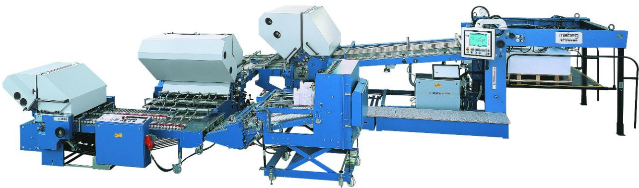
Signaturenproduktion auf zwei Großformat-Taschenfalzmaschine T 1420
